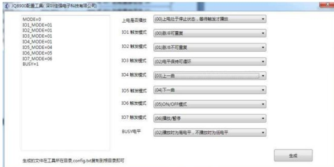
对每个 IO 口进行配置好后，点生成，就自动在配置工具所在目录生成一个 config.txt 文件，然后将 config.txt 文件复制到控制器所在的 U 盘即可。
